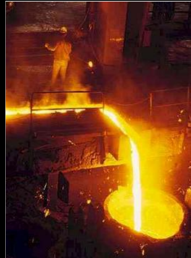
Coulée de fonte issue d'un haut fourneau
