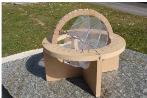
Figure 10. Sphère armillaire réalisée par Émile Séchaud, montrant la trajectoire du Soleil au solstice d'été, aux équinoxes et au solstice d'hiver (les trois disques de plexiglas).
